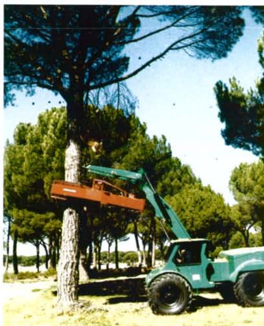
FOTO 69 Recolección mecanizada de la piña. La máquina sujeta al árbol con una pinza y, mediante el movimiento vibratorio, hace caer la piña del árbol. En la foto se aprecian piñas cayendo y piñas en el suelo.
