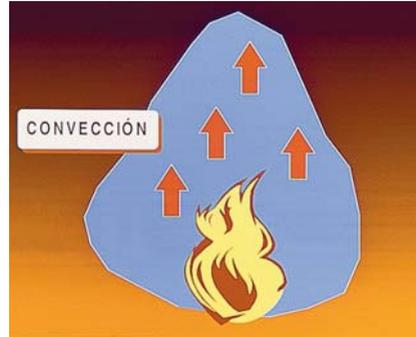
Puede observarse que si situamos un papel encima de una llama sin que la toque, éste se calienta hasta llegar a su temperatura de ignición y empieza a arder.
