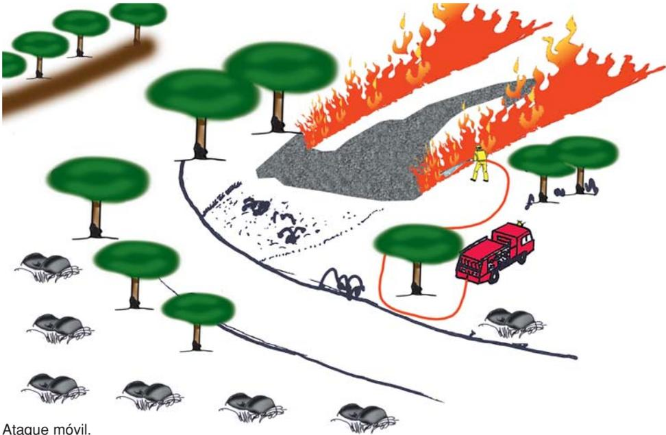
Para ello, el vehículo se desplaza recorriendo el borde del incendio y el operador de la lanza aplica el agua paralelamente al incendio, a la base de la llama.
