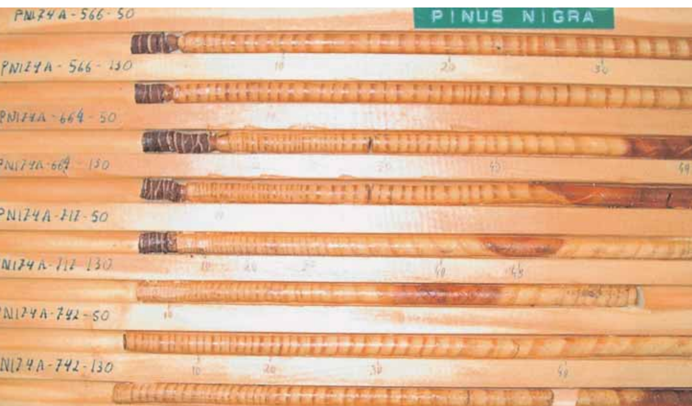
Figura 51. Probetas obtenidas con barrena de Pressler, para el estudio de la edad y los crecimientos.
