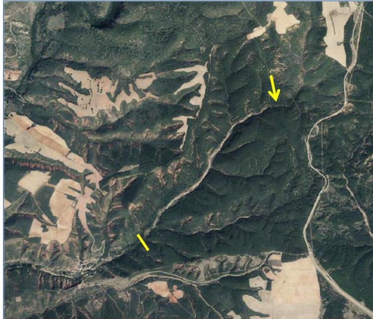
Foto 5 - En la ortofoto se señala con un segmento la situación del dique y con la flecha el final del aterramiento, que sigue aumentando. Se visualiza dicho aterramiento en color claro.
