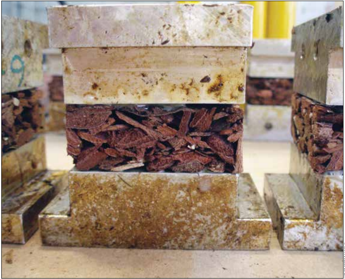
Muestra de ensayo (50 x 50 x 20 mm 3 ) para pruebas del encolado interno
