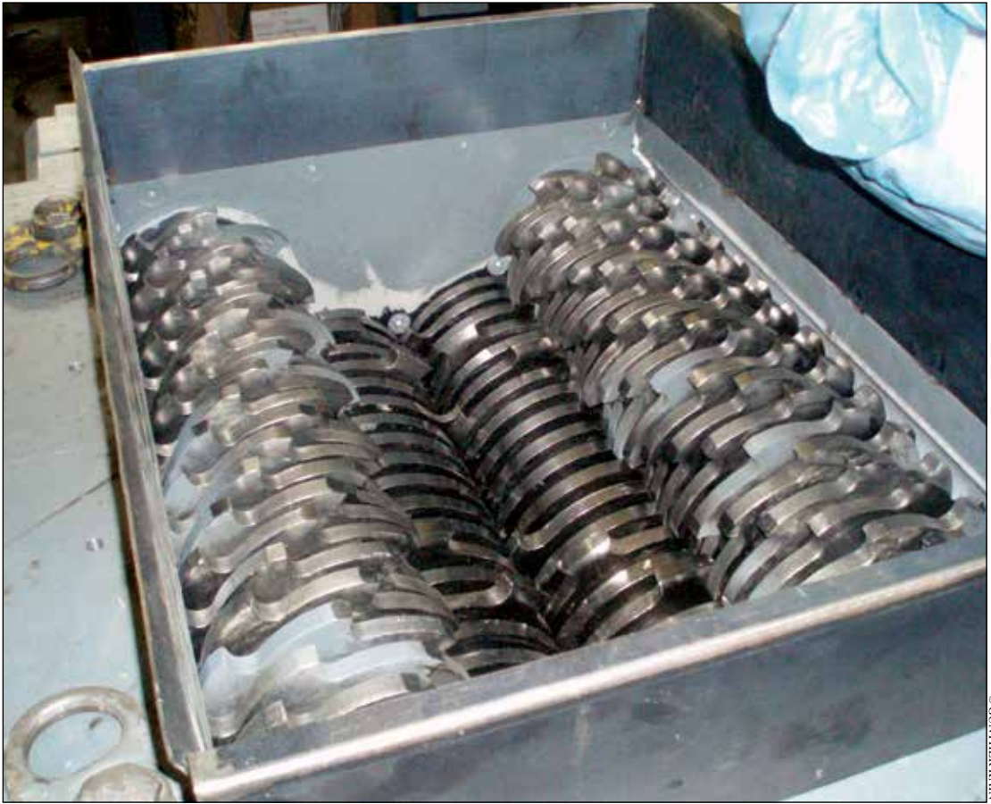
Trituradora de cuatro ejes Untha Golling ( 6 \leq x \leq 10 mm)
