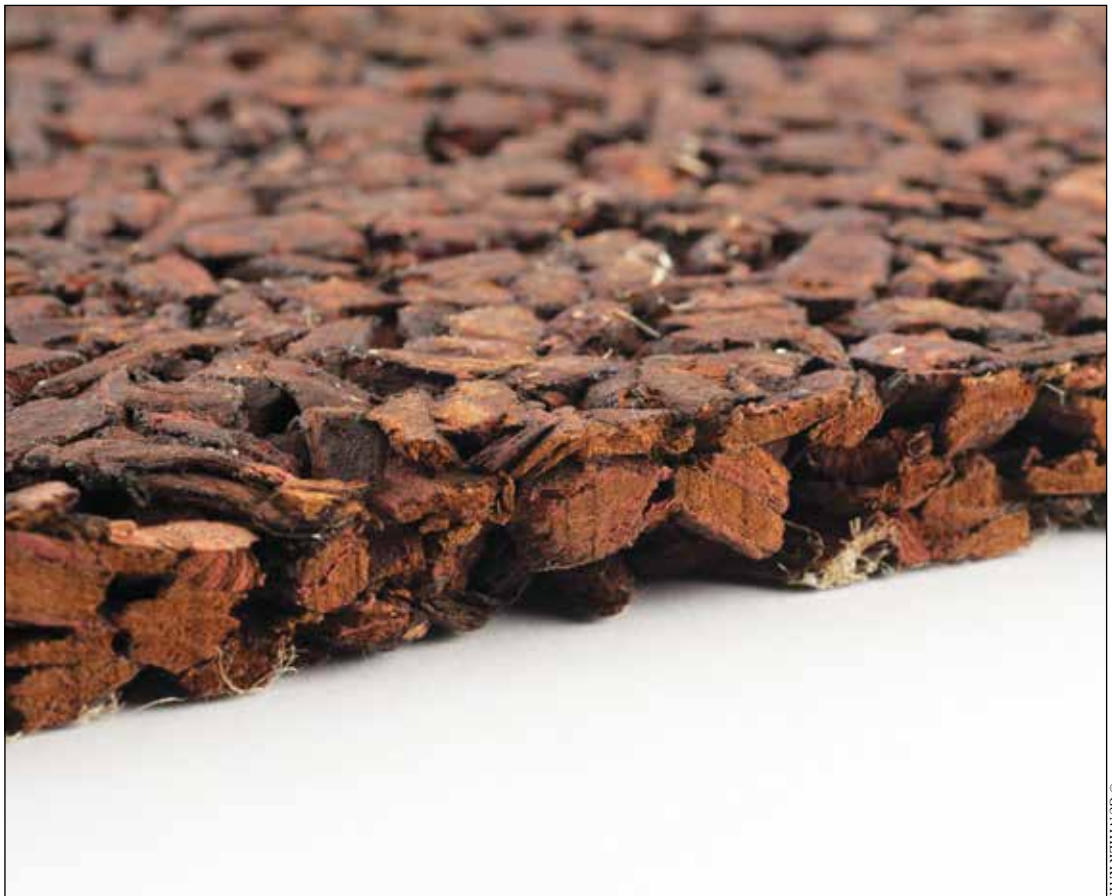
Panel de aislamiento de corteza de alerce unido con resina de tanino (espesor = 20 mm, densidad = 350 kg/m 3 )
