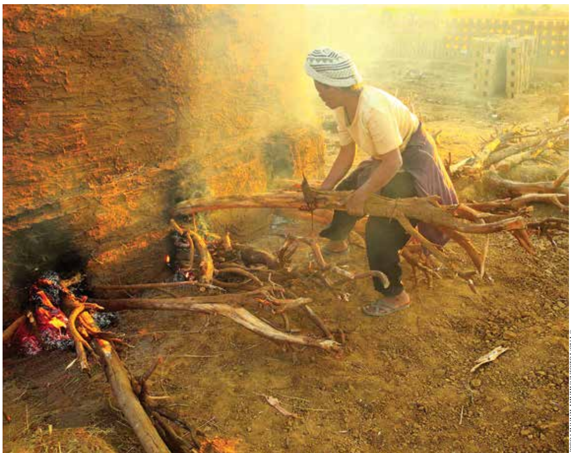
▶ Tolojanahary Ranaivosoa (Madagascar) Cocción de ladrillos en horno de leña
