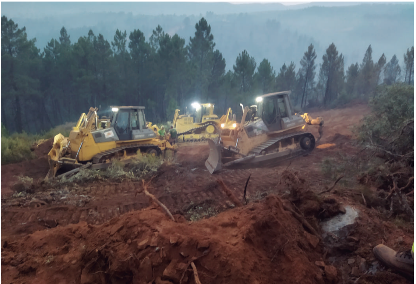
Detalle de trabajos en ataque directo y paralelo de la maquinaria pesada (haciendo hasta ocho pasadas con siete equipos de maquinaria) que logró contener el avance del GIF de Monsagro (Salamanca) en el sector oeste, durante toda la noche siguiente, una vez disipado el pirocúmulo
